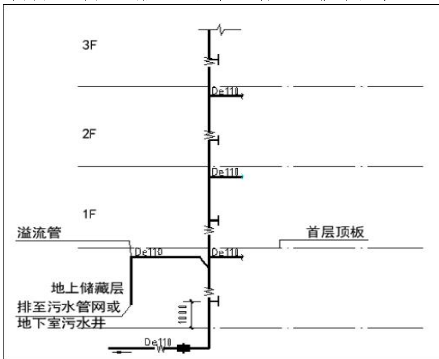
带地上储藏室层的住宅排水溢流管（首层顶板下安装）示意图
